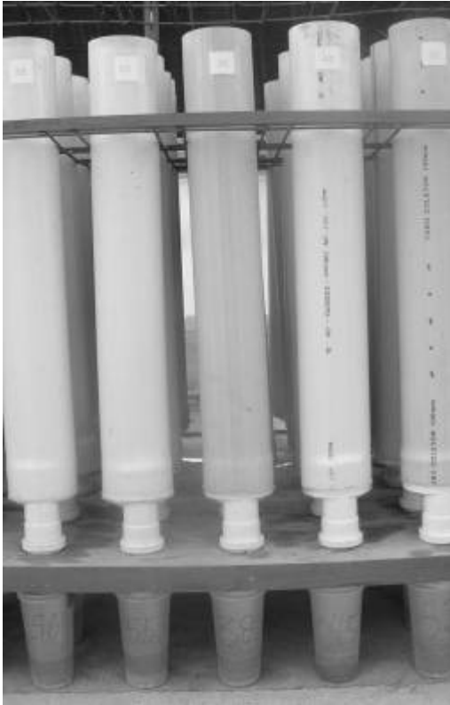
Figura 7. Colunas de solos dispostas na mesa e a descontaminação da brita n°1 em solução HCL 5%.
