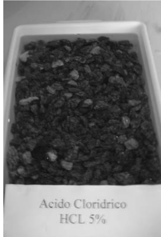
Figura 7. Colunas de solos dispostas na mesa e a descontaminação da brita n°1 em solução HCL 5%.
