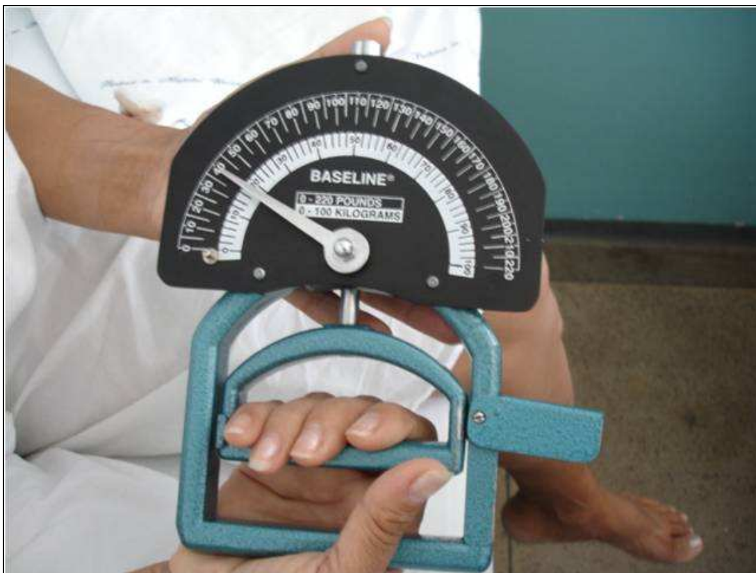
Figura 6. Aparelho utilizado para avaliar a força de preensão palmar
