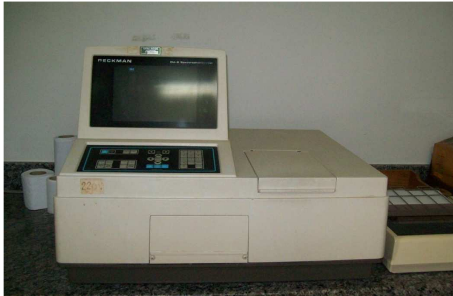
Figura 17. Espectrofotômetro utilizado na determinação do \text{Fe}_2\text{O}_3 ( \lambda=510\text{nm} ), \text{TiO}_2 ( \lambda=380\text{nm} ) e \text{PO}_4 ( \lambda=830\text{nm} )
