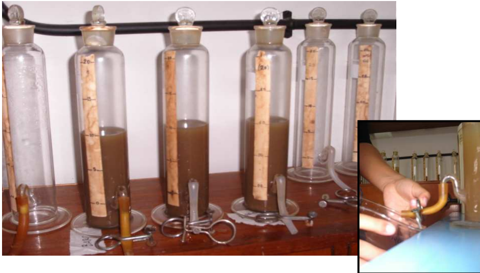
Figura 13. Separação das frações silte-argila utilizando o Cilindro de Attenberg.
