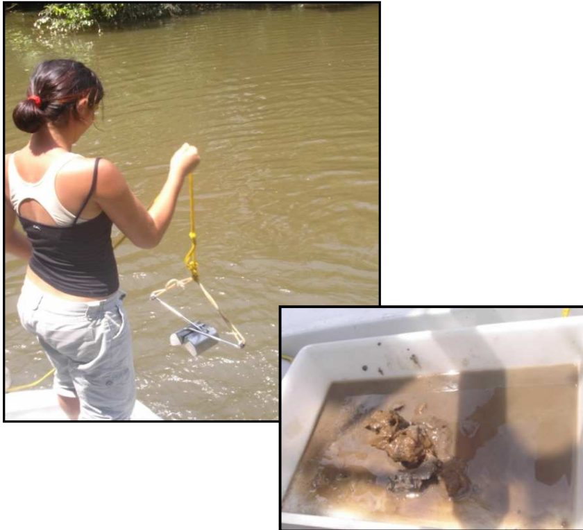
Figura 10. Coleta de amostra com a Draga de Petersen.
