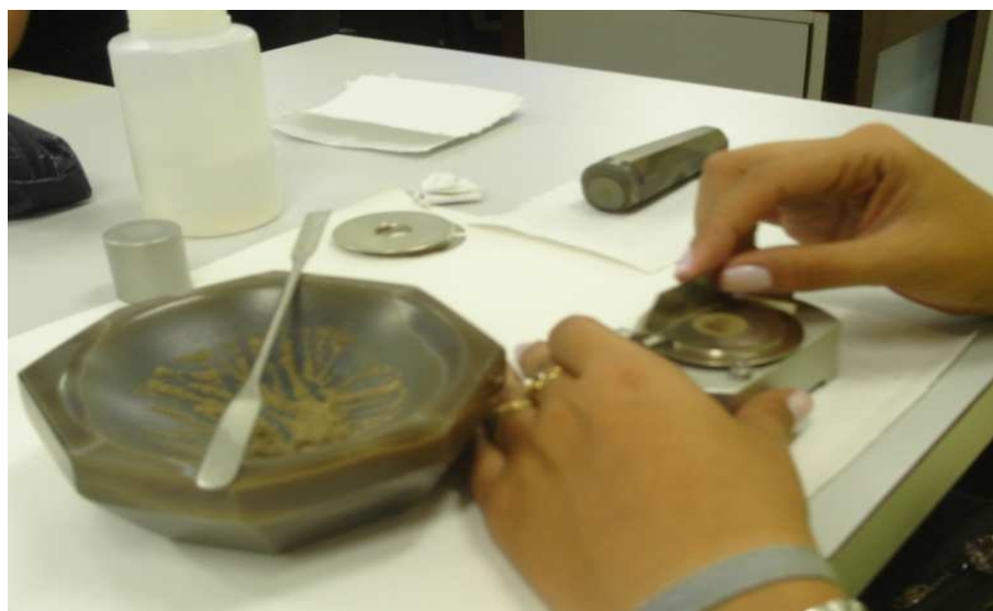
Figura 14. Preparação de amostras para a análise da mineralogia da amostra total dos sedimentos de fundo.
