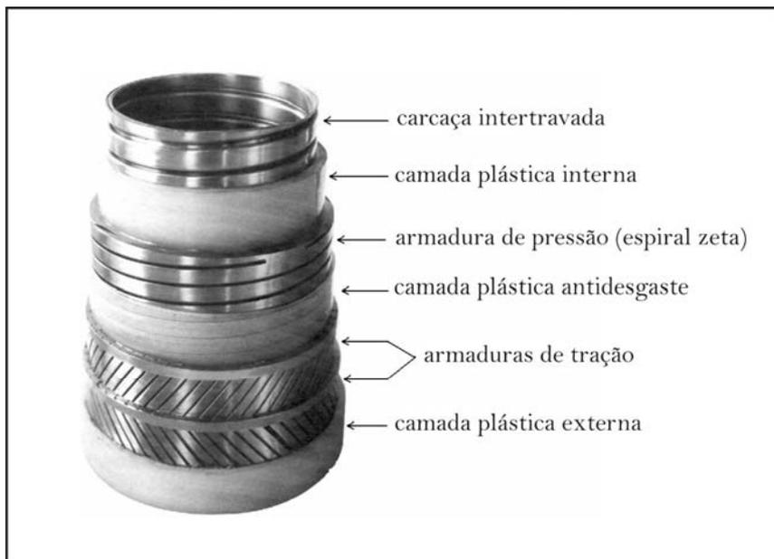
**Figura 3.17: Camadas que conformam um *riser* flexível**
