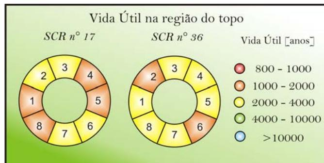
**Figura 5.11: Danos no Topo dos SCRs analisados**
