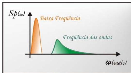
**Figura 1.6: Espectro de tensões bi-modal**
