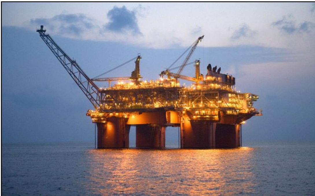
**Figura 3.13: Plataforma Tipo Semi-submersível**
