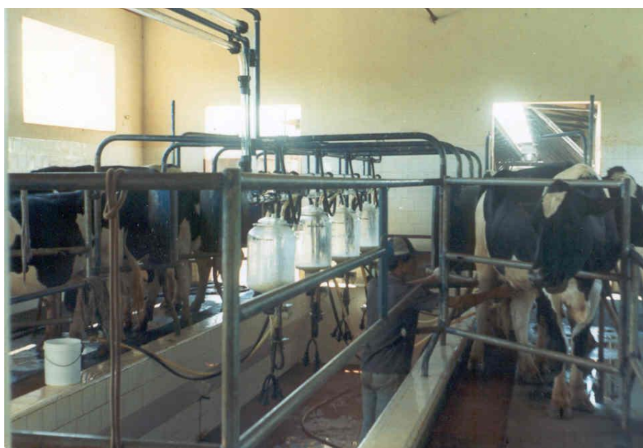
FIGURA 26 - ordenhadeira mecânica instalada fazenda Pestalozzi na década de 1980 15
