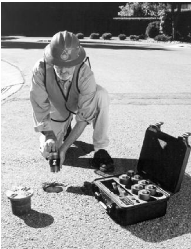
Figura 3.37 - Correlacionador de Ruídos Multiponto (cortesia LAMON 2009)
