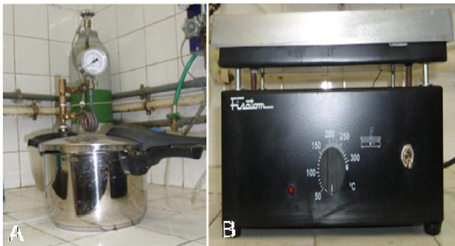
Figura 4.9 Primeiro mecanismo gerador de vapor adotado. A) Painel de pressão de 6 litros adaptada, B) Placa aquecedora elétrica.
