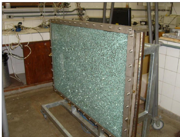
Figura 4.8. Vidro laminado em pedaços após realização do primeiro teste de estanqueidade.
