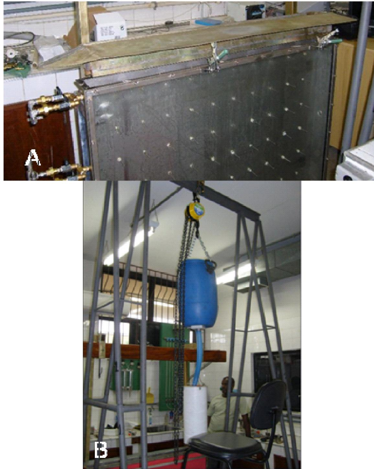
Figura 4.12 A) Calha usada para auxiliar na pluviação de areia, B) Pórtico para uso no sistema de pluviação com uso de bombonas de areia inicialmente adotado
