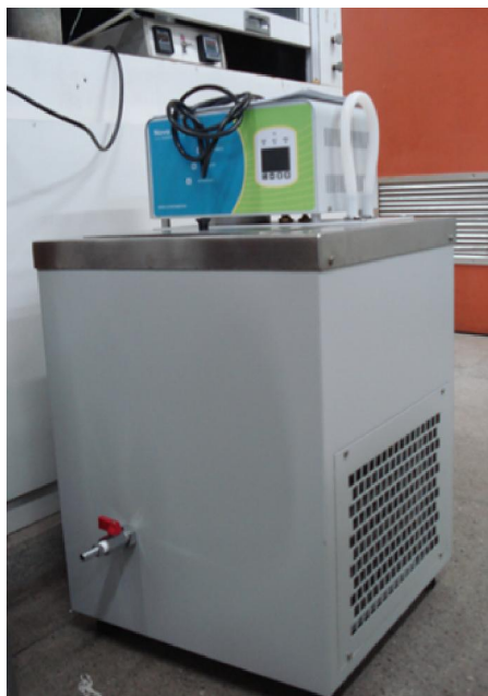
Figura 4.17 Banho térmico usado para refrigeração do condensador.
