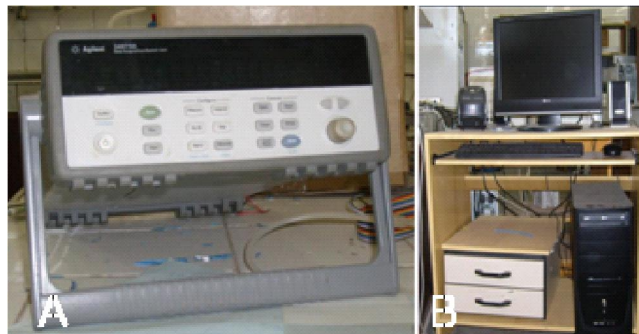
Figura 4.14. Sistema de aquisição de dados: A) Data Logger. B) Computador com software para leitura em tempo real.
