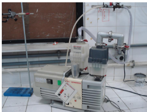
Figura 4.18 Bomba à vácuo usada no terceiro lote de ensaios.
