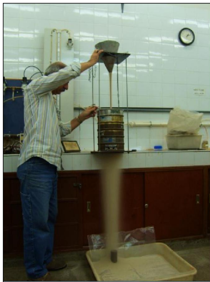
Figura 5.2 Verificação da influência da altura de pluviação no índice de vazios.
