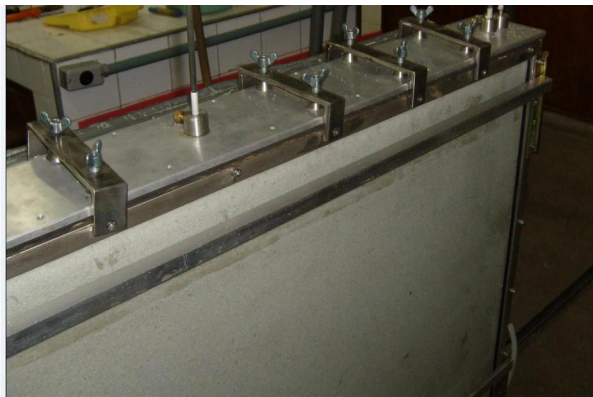
Figura 4.4 Tampa superior de alumínio com garras metálicas para fixação onde se visualiza o furo central (inserção de contaminante) e os furos da borda direita (poços de extração de efluentes).
