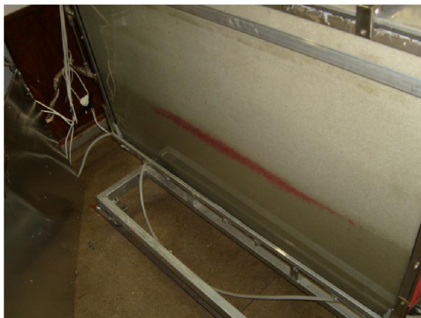
Figura 5.3 Ensaio preliminar onde se vê uma fase livre de tolueno sobre o NA.
