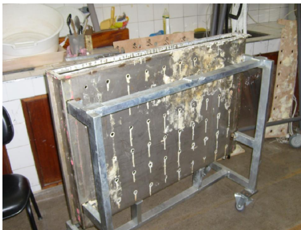
Figura 4.7 Primeira caixa após a retirada dos eletros, vidro frontal e tampa superior.
