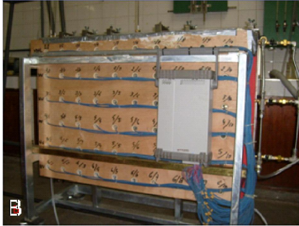
Figura 4.3(B) Vista de fundo da caixa com instalação dos termopares e Data Logger.
