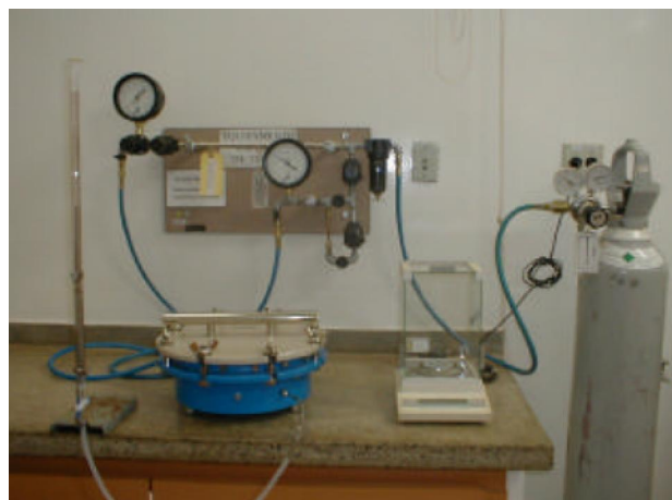
Figura 5.2 Câmara de pressão de Richards
