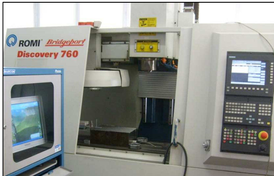
Figura 3.4 – Centro de usinagem vertical, modelo Discovery 760 (ROMI).
