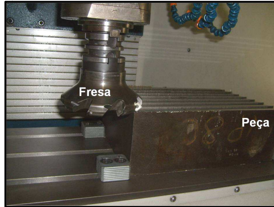
Figura 2.6 – Representação de um fresamento frontal.
