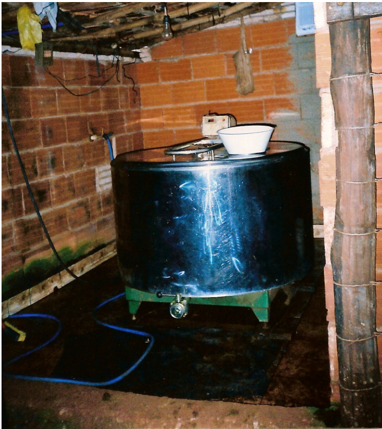
Figura 13 – Comunidade da Canoa (Ituiutaba/MG): tanque de expansão
