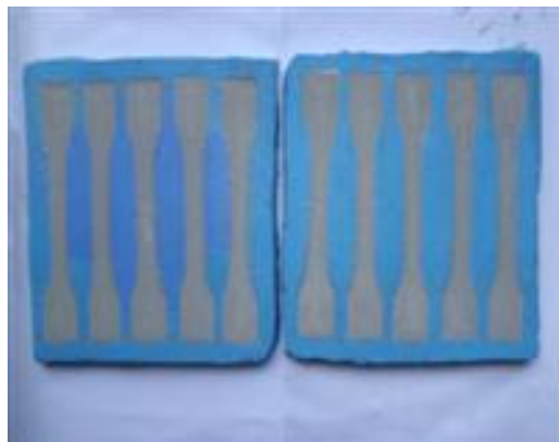
Figura 17: Moldes de silicone com o adesivo epóxi depositado.
