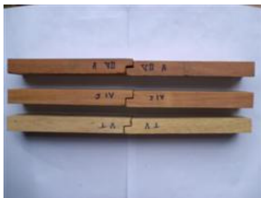
Figura 26: Amostra dos corpos de prova das juntas encaixadas confeccionados com Angelim-pedra, Jatobá e Tauari.
