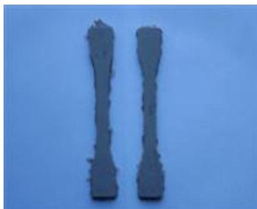
Figura 18: Corpos de prova do adesivo epóxi após os desmoldes.
