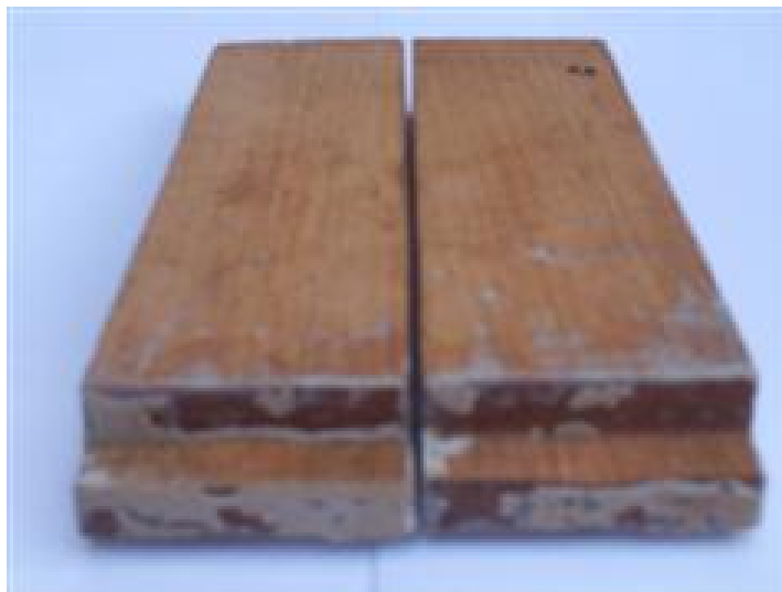
Figura 52: Representação da ruptura típica das juntas coladas encaixadas confeccionadas com o Jatobá.
