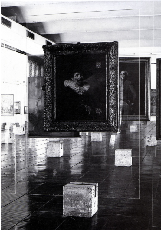
Pinacoteca. Cavalete de cristal. Parte posterior com legendas descritivas e detalhe da fixação da tela na placa de vidro temperado. A cunha em madeira é fixada na base em concreto por aparafusamento. Fonte: História do MASP. 1992. p. 109.
