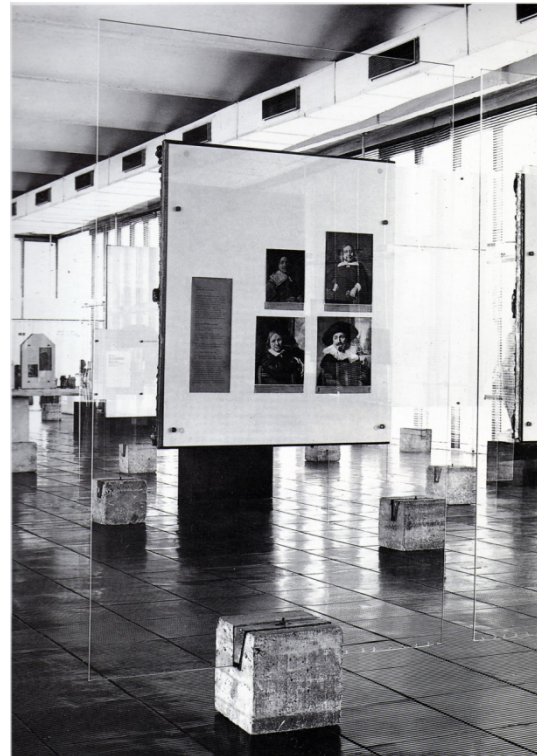
Pinacoteca. Cavalete de cristal. Parte posterior com legendas descritivas e detalhe da fixação da tela na placa de vidro temperado. A cunha em madeira é fixada na base em concreto por aparafusamento. Fonte: História do MASP. 1992. p. 109.
