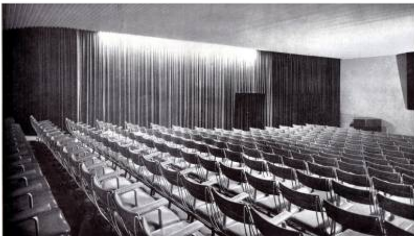
Interior do grande auditório com capacidade para 350 lugares destinado a projeção de filmes e concertos. Teto acústico em persiana contínua permitindo a passagem do ar-condicionado. Cortina em algodão azul escuro, teto branco e tapete de lã bege. A cadeira desenhada por Lina Bo Bardi com assento reclinável, estrutura em aço com encosto e assento em plavinil cinza. Fonte: BARDI, P.M. The Arts in Brazil, 1956, p. 109.
