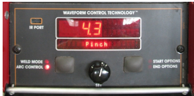
Figura 6.1 – Painel auxiliar do alimentador de arame (controlador de forma de onda) do equipamento Power Wave 455/STT da Lincoln Electric, mostrando a opção de regulagem do efeito pinch
