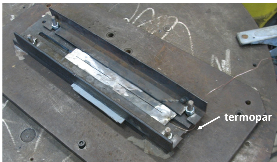
Figura 11.1 – Suporte com a placa de teste montada, onde se pode ver o termopar saindo por debaixo da placa
