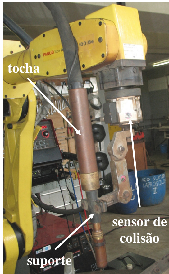
Figura 3.9 – Fixação da tocha de soldagem a flange do robô mostrando o sensor de colisão e o suporte para prender a tocha ao sensor
