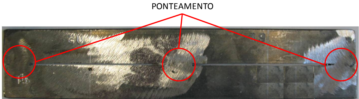
Figura 3.12 – Posição do ponteamento realizado na placa de teste com junta em I e folga de 1,5 mm (notar a presença dos espaçadores e o esmerilhamento para retirada do excesso dos pontos)
