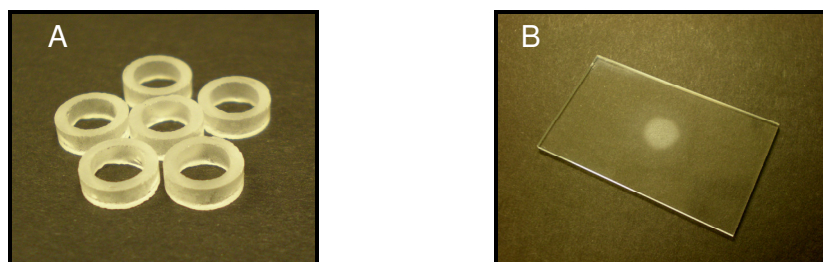
Figura 4.9 - Tubos de vidros cortados e jateados com óxido de alumínio (A) e lâmina jateada no centro com óxido de alumínio
