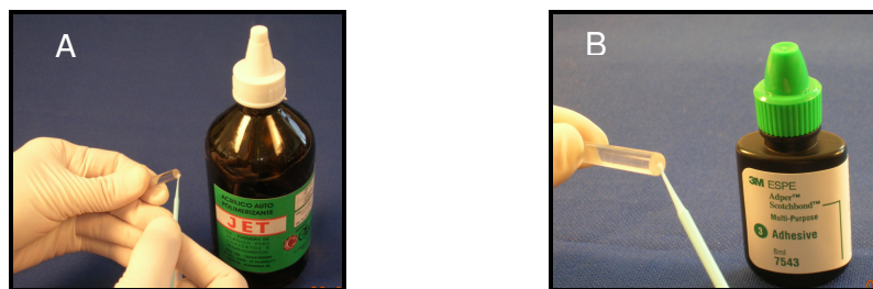
Figura 4.4 - Tratamento dos bastões de acrílicos com monômero metilmetacrilato (A) e adesivo Scotchbond Multi Plus frasco 3 (B)
