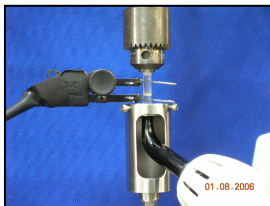
Figura 4.5 - Sistema de teste para determinação da tensão de polimerização, com extensômetro acoplado e aparelho fotopolimerizador em posição
