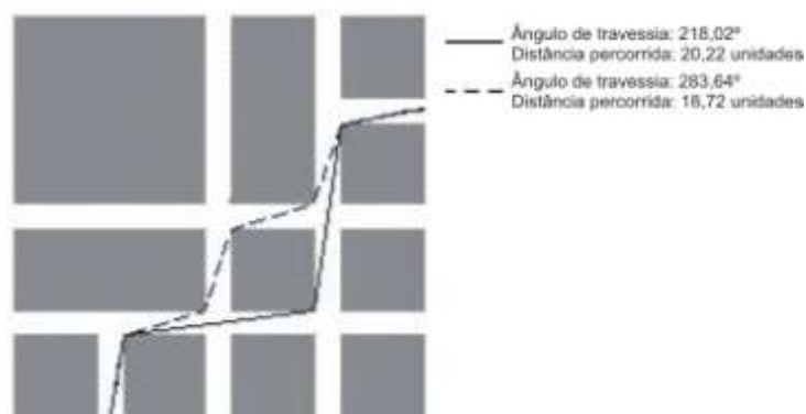
Figura 3.19: Caminho Euclidiano Mínimo e Caminho Angular Mínimo entre dois pontos em um espaço bidimensional. Fonte: TURNER (2000).
