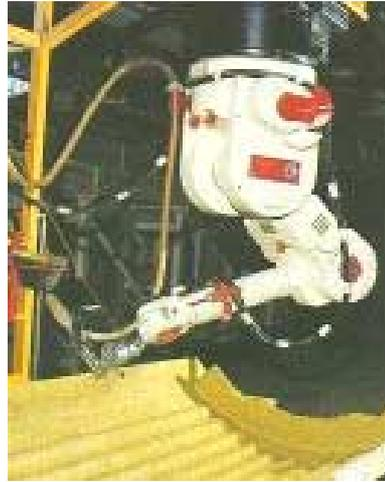
Figura 4.6: Equipamento para projeção mecânica (GRCA, 1995).
