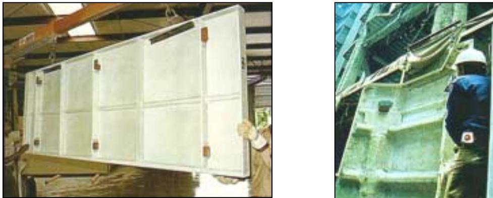
Figura 4.9: Nervuras para enrijecimento de painéis GRC (PCI, 1995).
