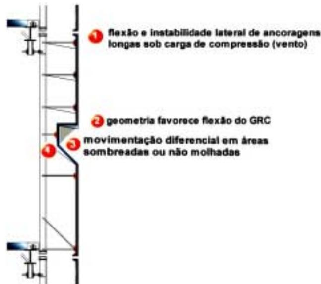
**Figura 4.12:** Influência da geometria dos painéis sobre a natureza das tensões atuando na camada de GRC (SILVA, 1998<sub>b</sub>).
