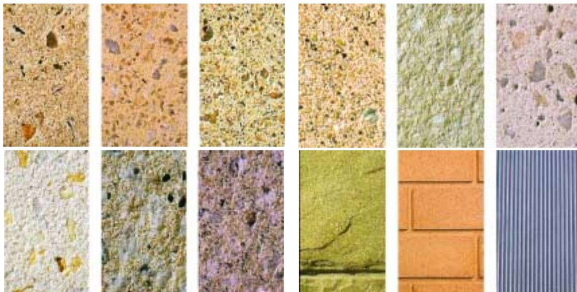
**Figura 4.11: Acabamentos superficiais para painéis de GRC (PCI, 1995).**
