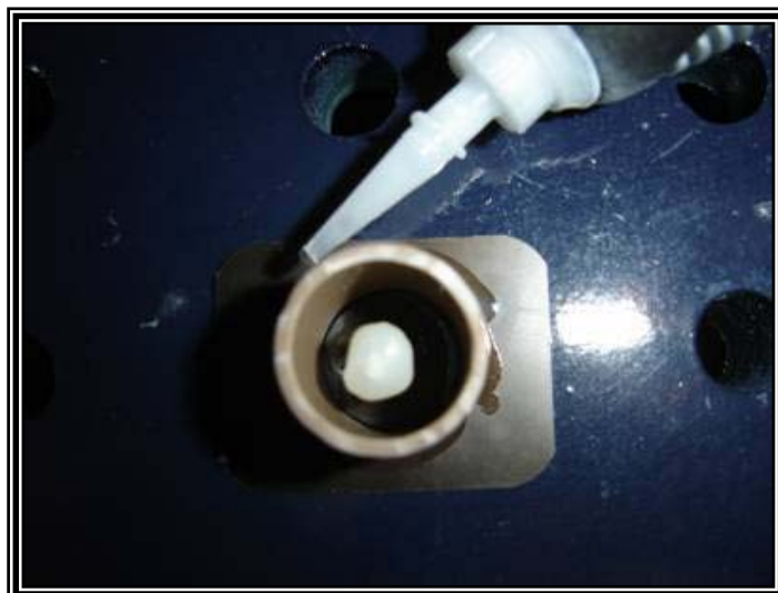
Figura 12 - Anel de PVC posicionado e vedado com cianocrilato.
