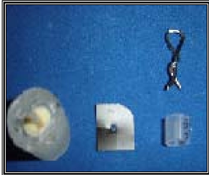
Figura 26 - Amostra com pino posicionado, na sequência: película radiográfica perfurada e alça para confecção da amostra e tubete para inclusão da resina acrílica.
