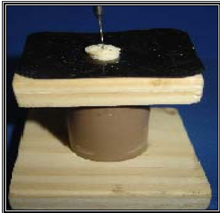
Figura 9 - A haste vertical do delineador foi movimentada até a perfuração da película.
