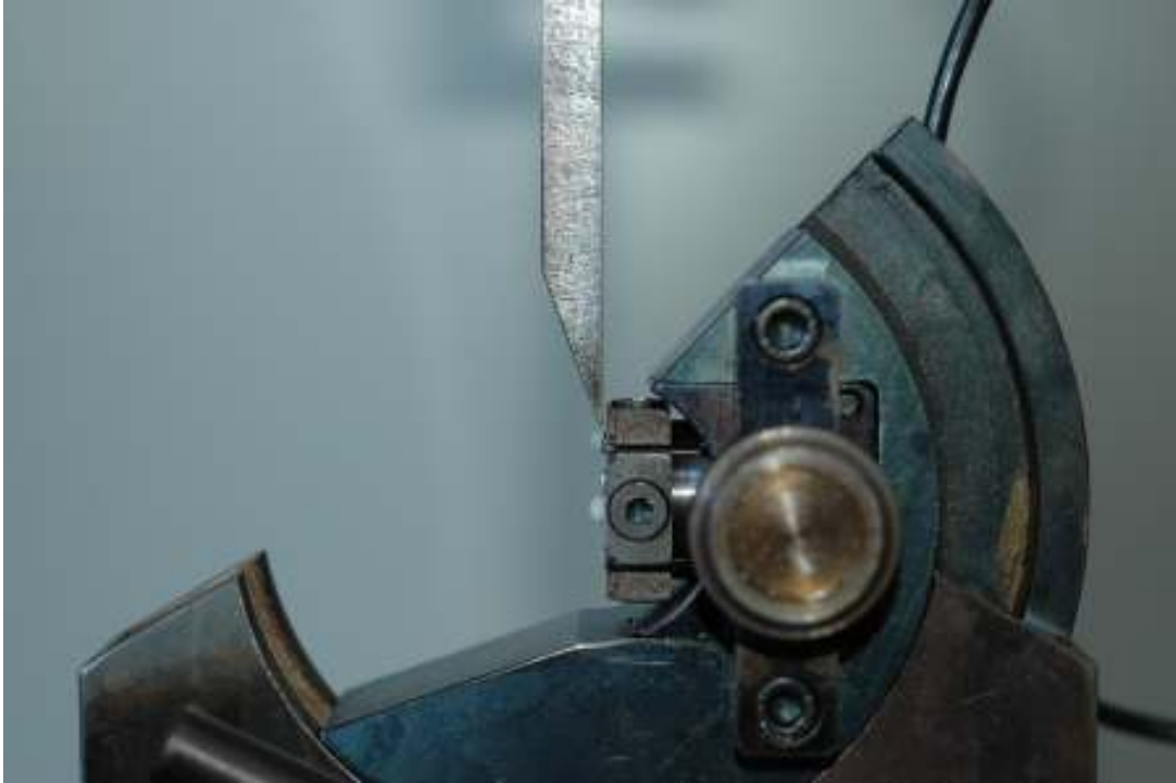
Figura 12 - Dispositivo de Faria & Mondelli acoplado à máquina de ensaio podendo-se visualizar a ponta de aço inoxidável aplicando o carregamento axial para o teste de cisalhamento.
