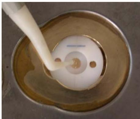
Figura 13 - Condensação da resina composta no interior da matriz.
