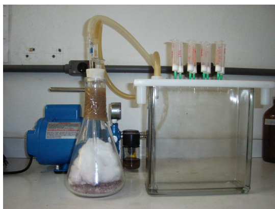
Figura 4. 4: Manifold utilizado para extração em fase sólida
