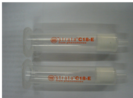
Figura 4. 3: Cartucho C18 Strata (Phenomenex) com 500mg de fase sólida
