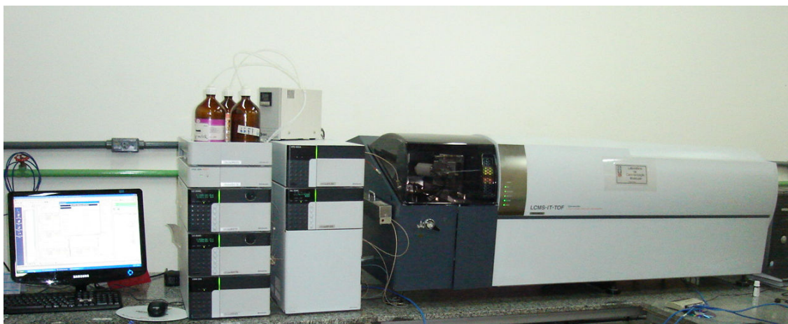
Figura 4. 9: Cromatógrafo líquido acoplado ao espectrômetro de massas - HPLC-MS-IT-TOF (Shimadzu)
