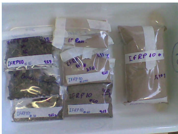
Figura 2.7: Amostras de sedimentos peneiradas com as diferentes frações granulométricas.
