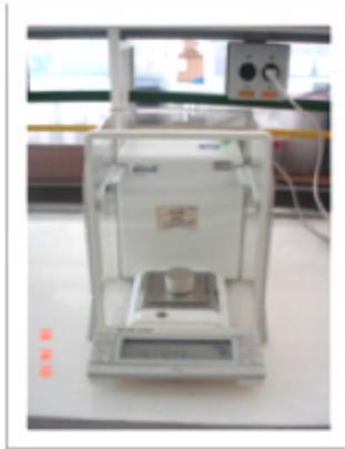
**Figura 16 – Fotografia da balança de precisão utilizada na aferição do teor de umidade**
