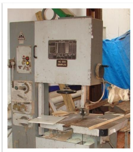
**Figura 20 – Fotografia da serra de fita utilizada na extração dos corpos de prova**
