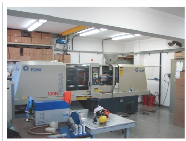
**Figura 18 – Fotografia da injetora ROMI, utilizada no processamento da matéria-prima para obtenção dos produtos reciclados**
