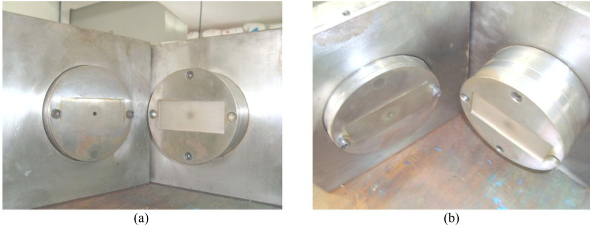
**Figura 19 – Fotografias do molde utilizado na moldagem das chapas de PET reciclado**
