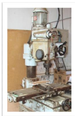
**Figura 22 – Fotografia da fresadora utilizada para obtenção do corpo de prova de tração**
