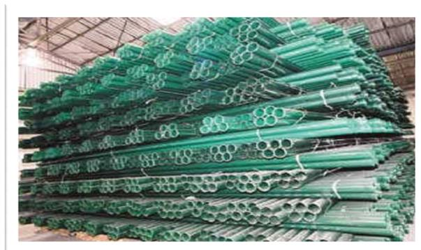
**Figura 9 - Tubos de PET reciclado para esgotos fabricados pela EBR**
