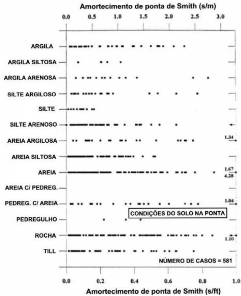
Figura 2.18: Correlação entre o coeficiente de amortecimento de ponta de Smith e o tipo de solo (Paikowski & Chernauskas, 1996).
