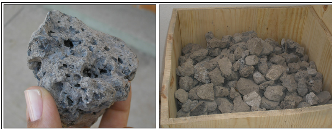
Figura 2.19 – Escória de aciaria, obtida pelo processo LD, da USIMINAS.
