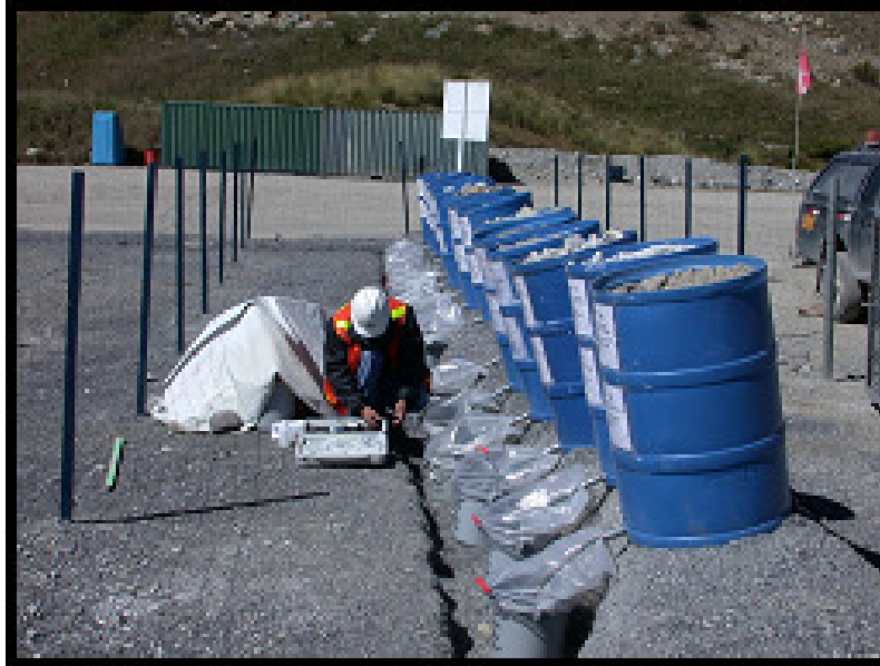
Figura 2.11 - Exemplo de teste in situ : field barrel tests (Mills, 1995).
