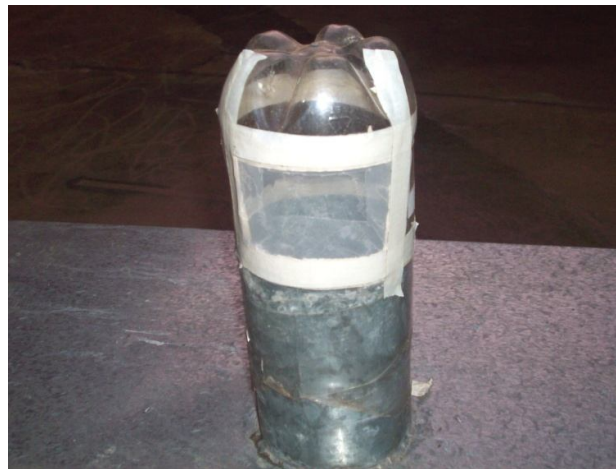
Figura 31. Detalhe da secção de garrafa PET adaptada como coletor de alados, observando-se a janela de ventilação com organza. A peça está encaixada no bocal da urna, que tem a mesma secção transversal.
