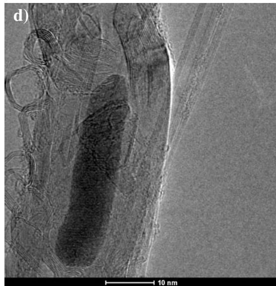
FIGURA. 44. Imagens de microscopia eletrônica de transmissão dos NCs crescidos sobre o sistema \text{FeMo}_{1,00} ppt.
