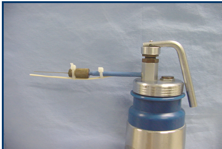
Figura 9 - Fixação do cilindro de PVC para padronização da distância de aplicação do nitrogênio líquido
