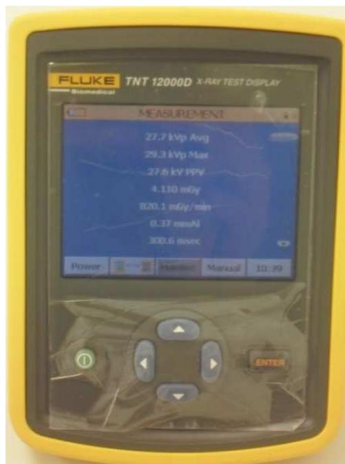
Figura 21: Valores medidos pelo detector após uma única exposição
