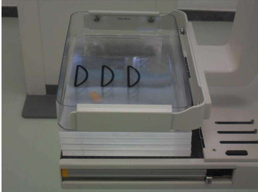
Figura 29: Posicionamento do objeto de teste da resolução espacial
