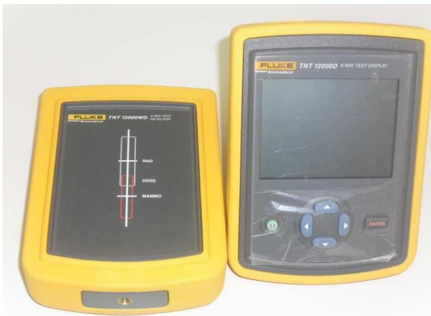
**Figura 20: Detector de estado sólido e eletrômetro**
