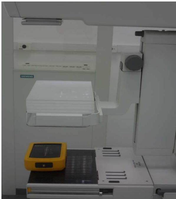
**Figura 25: Posicionamento do detector para o teste da linearidade**
