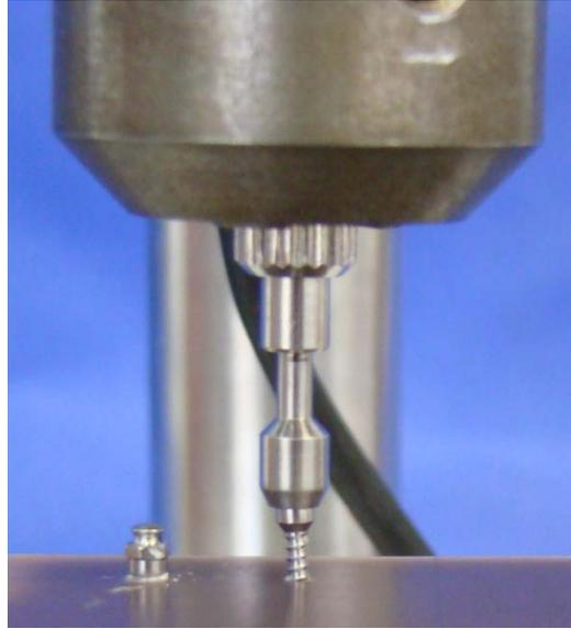
Figura 5 - Torquímetro digital Lutron, modelo TQ-8800 com mini-implante.
