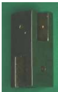
Figura 15 - Dispositivo torneado para encaixe no prolongamento das coroas e na máquina de teste.
