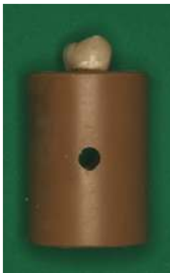
Figura 2 – Tubo de PVC com o dente incluído e com perfuração transversal no centro para fixação na base utilizada para o teste.
