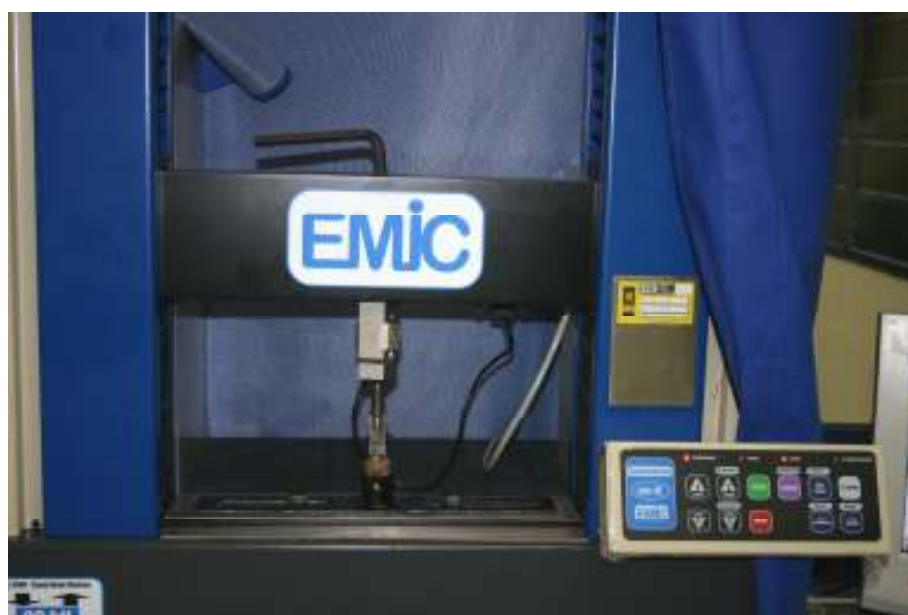
Figura 14 - Máquina Emic, utilizada para o teste de tração.
