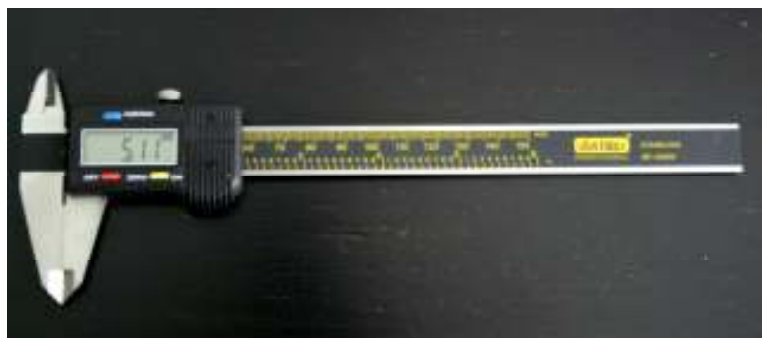
Figura 1 – Paquímetro digital utilizado para medir as dimensões da coroa dental antes e após o preparo para coroa total
