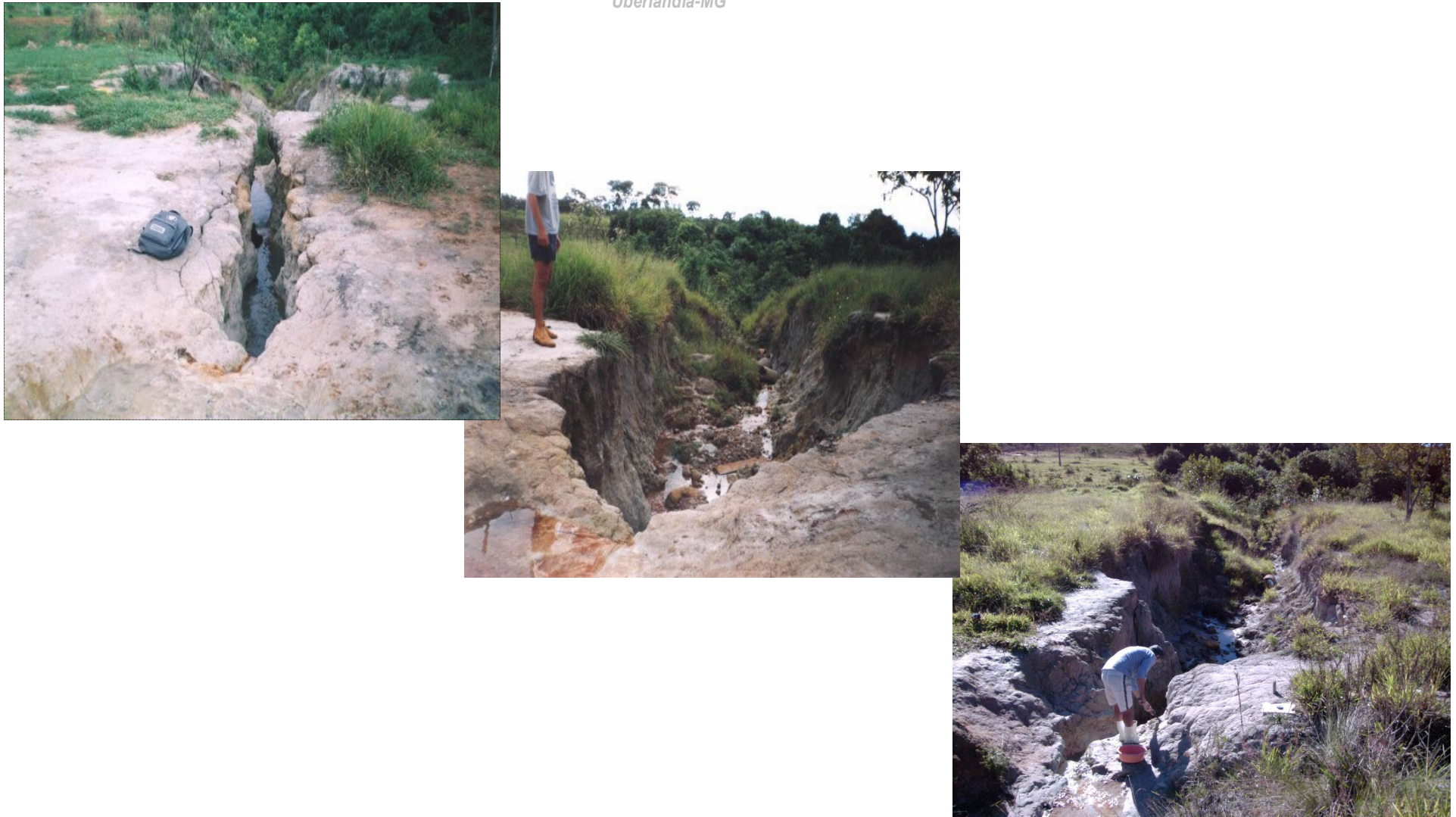
Figura 16, 17 e 18 – Da esquerda para direita percebe-se a evolução do canal da voçoroca com a erosão sendo ativada no período de chuvas (outubro/março. A primeira foto foi feita em outubro/2002, a segunda em abril/2003 e a terceira em abril/2004– Autor: Roberto R. Alves).
