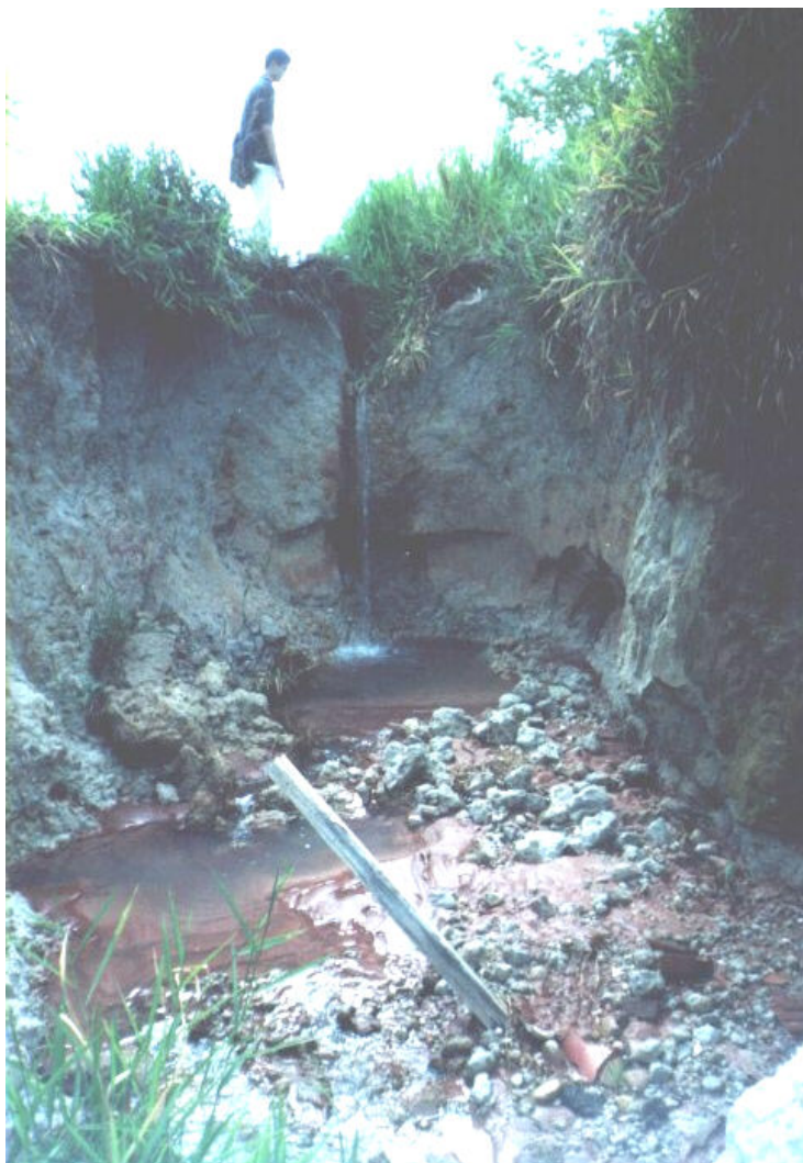
Figuras 12 – Processo erosivo no primeiro dia de monitoramento (02/02/2002) ainda pouco profundo e com avanço lateral inexpressivo, porém nota-se ravinamento nas paredes e um grande acúmulo de sedimentos dentro do corpo da voçoroca. Autor: Roberto Reis Alves – 02/02/2002
