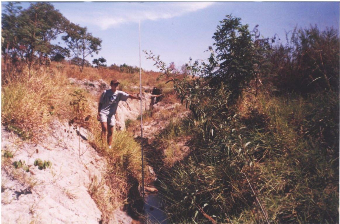
Figura 6 – Mostra a utilização do equipamento de medição das seções transversais. Autor: Roberto R. Alves – 06/2002
