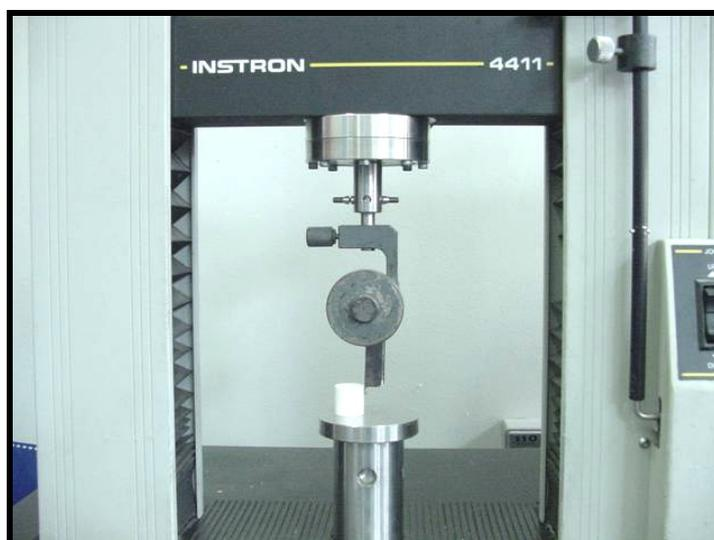
Figura 10 - Corpo-de-prova posicionado para o ensaio de resistência ao cisalhamento na máquina de ensaio Instron (modelo 4411).
