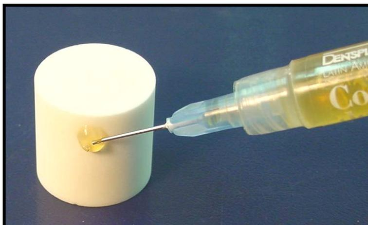
Figura 5 - Condicionamento da superfície do cilindro - ácido fluorídrico 10%.
