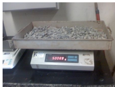
FIGURA 3.15 - QUARTEAMENTO E PESAGEM – MATERIAL GRAÚDO
