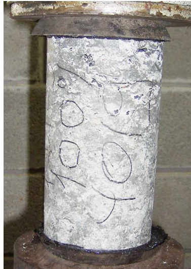
FIGURA 4.18 – CONCRETO MOLDADO COM RESÍDUOS - VAZIOS
