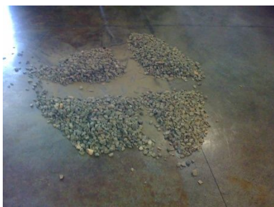
FIGURA 3.15 - QUARTEAMENTO E PESAGEM – MATERIAL GRAÚDO
