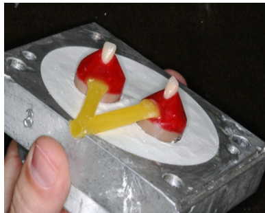
Figura 45 - Colocação do segundo conduto.
