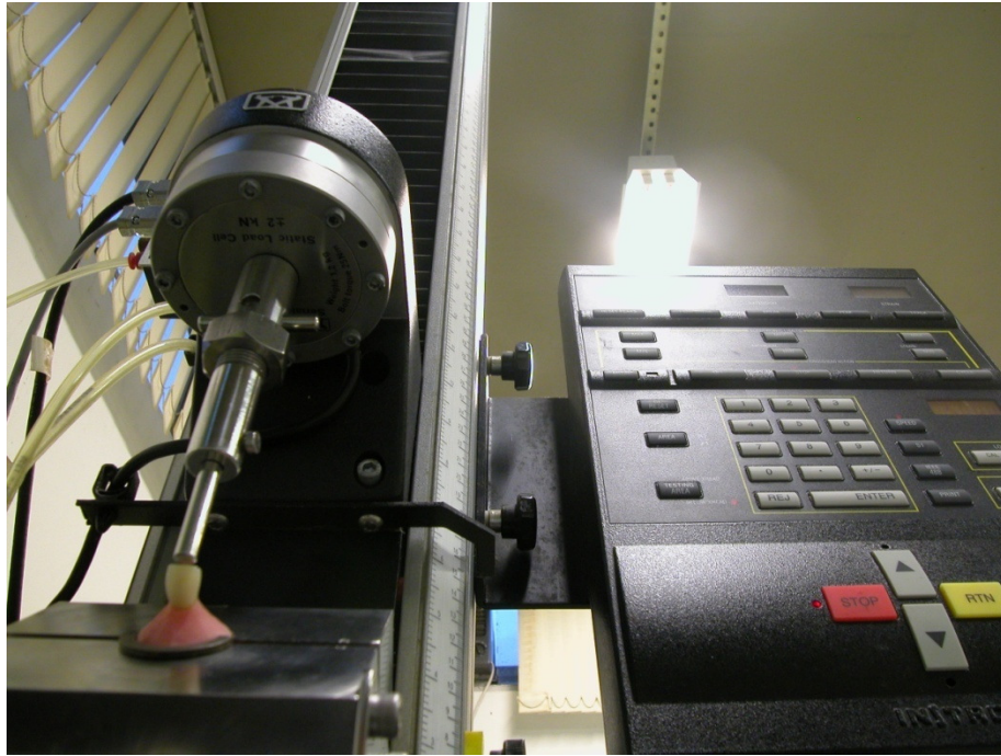
Figura 66 - Máquina de testes universal Instron 4444, com corpo de prova em 45°.
