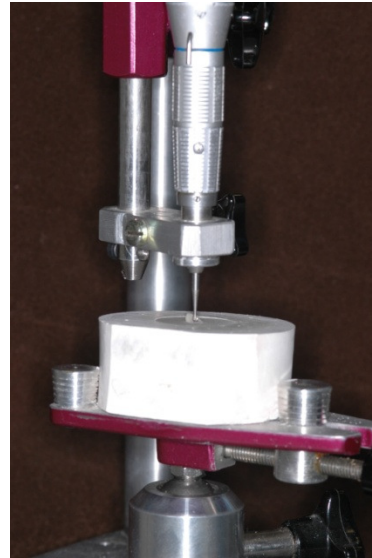
Figura 15 - Conjunto de perfuração sendo centralizado.
