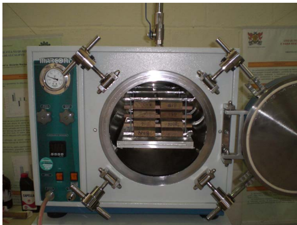
Figura 6 – Estufa à Vácuo com as amostras a serem tratadas.
