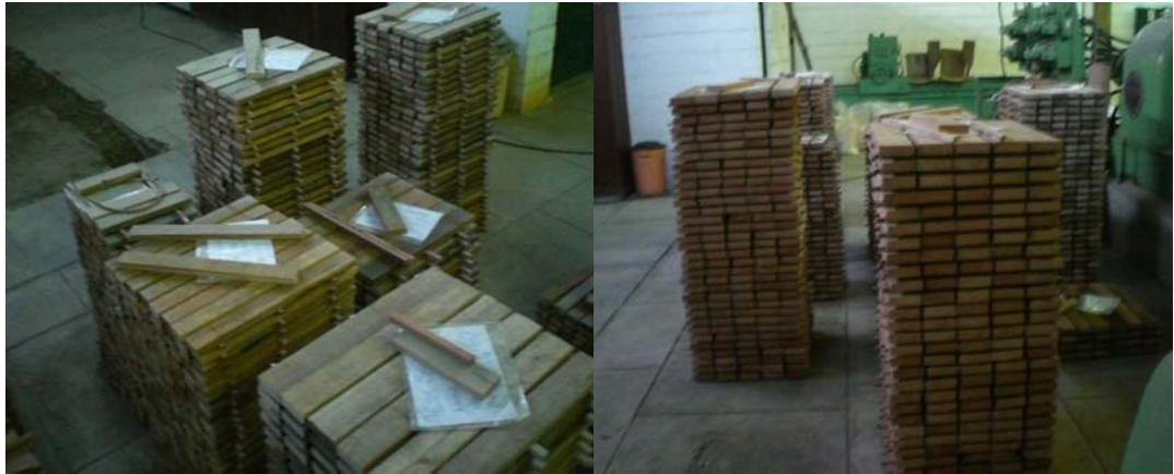
Figura 3b – Entabamento da madeira no Laboratório de Painel e energia da Madeira (LAPEM), preparada para o tratamento térmico
