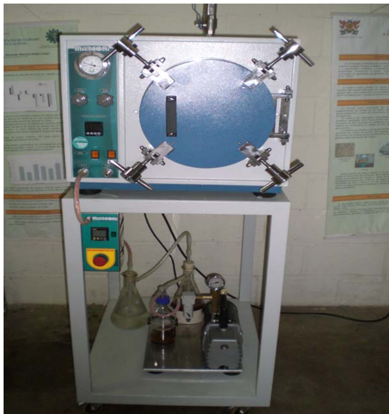
FIGURA 5 – Vista frontal da Estufa à Vácuo usada para os tratamentos térmicos.
