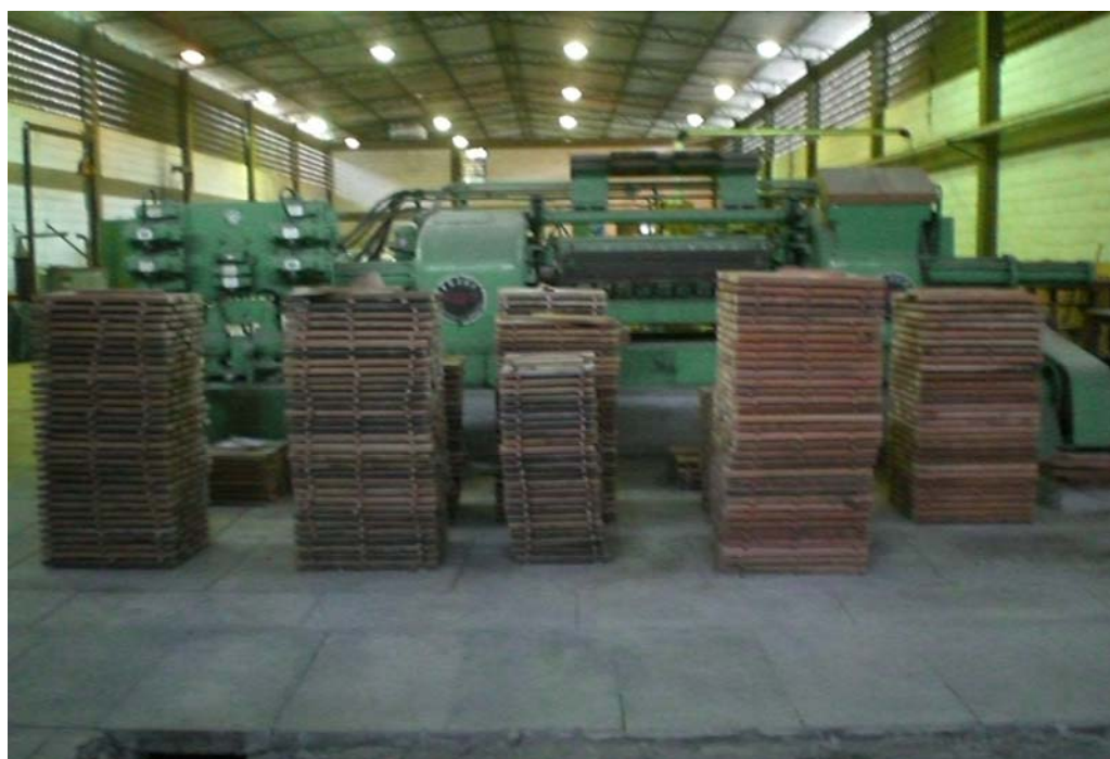
Figura 3b – Entabamento da madeira no Laboratório de Painéis e Energia da Madeira (LAPEM), preparada para o tratamento térmico.
