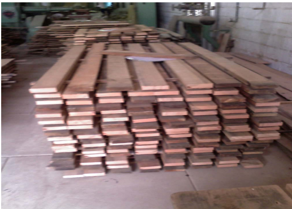
Figura 3a – Entabamento da madeira para secagem
