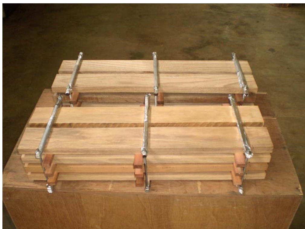
FIGURA 7A - Entablicamento e sistema para fixação das madeiras utilizadas nos tratamentos térmicos.
