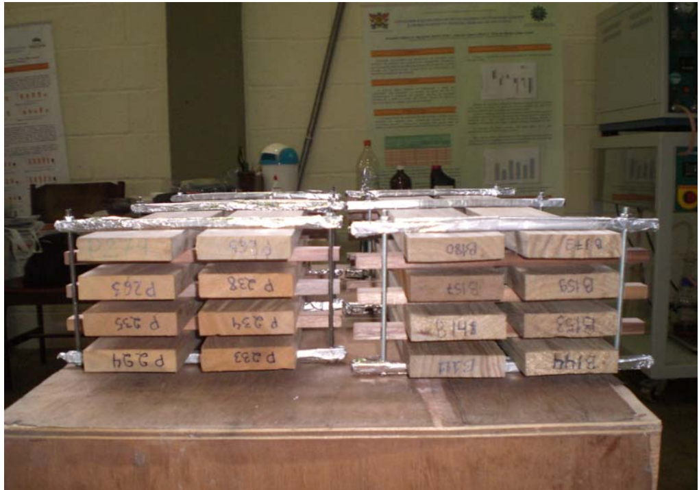
FIGURA 7B – Vista frontal das grades utilizadas para as amostras tratadas termicamente.
