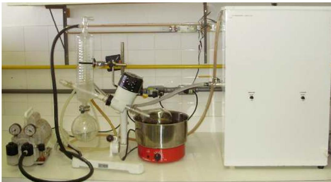
**Anexo 4:** Evaporador rotativo do laboratório de Microbiologia Imunologia/IBB/UNESP/Botucatu – utilizado para evaporação do solvente dos extratos.
