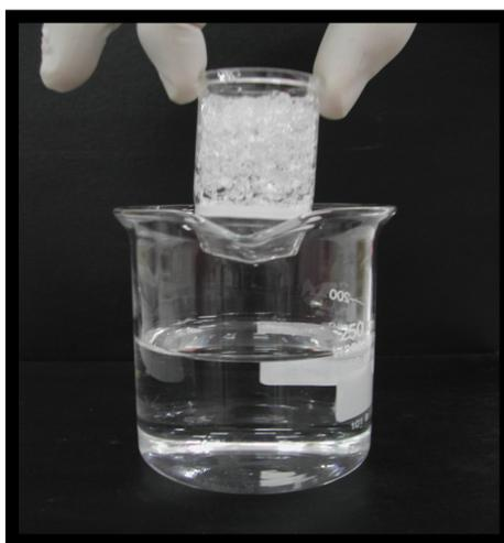
**FIGURA 13:** Sistema utilizado no estudo de intumescimento dos materiais, denominado método da imersão.
