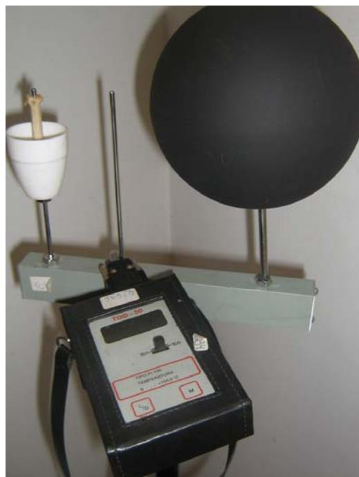
**Figura 13** - Termômetro de globo digital da Instrutherm modelo TGD-50 tipo Pt 100.
