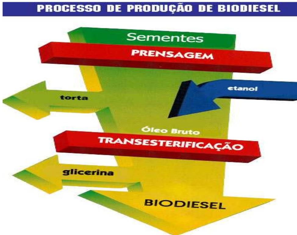
Figura 1 – Esquema simplificado do processo de produção de biodiesel.
