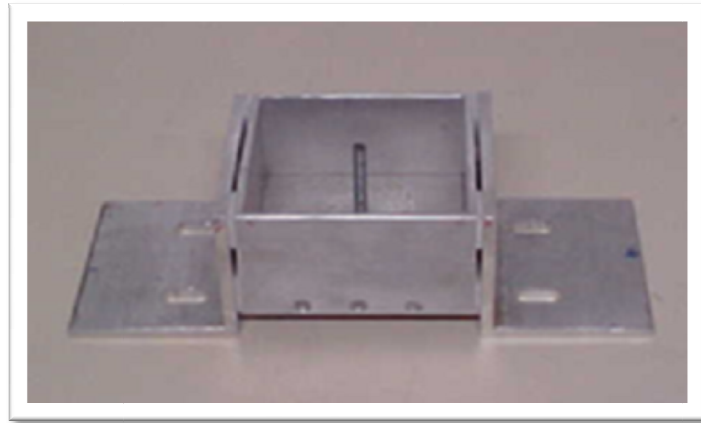
Figura IV. 3: Vista da caixa de alumínio com material viscoelástico e cantoneiras (Silva, 2007)
