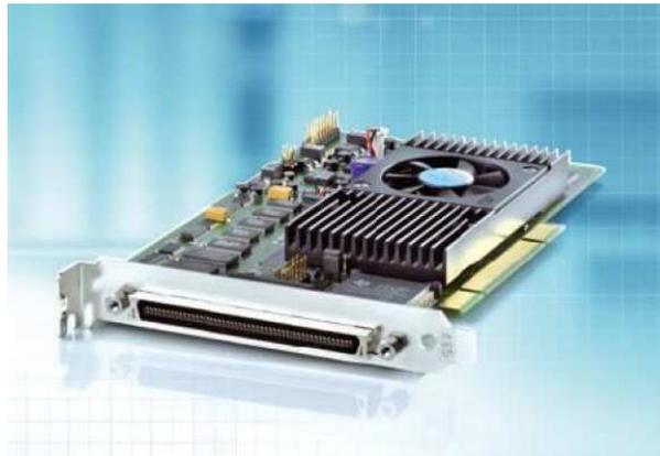
Figura 4.18: DS1104 *Controller Board*
