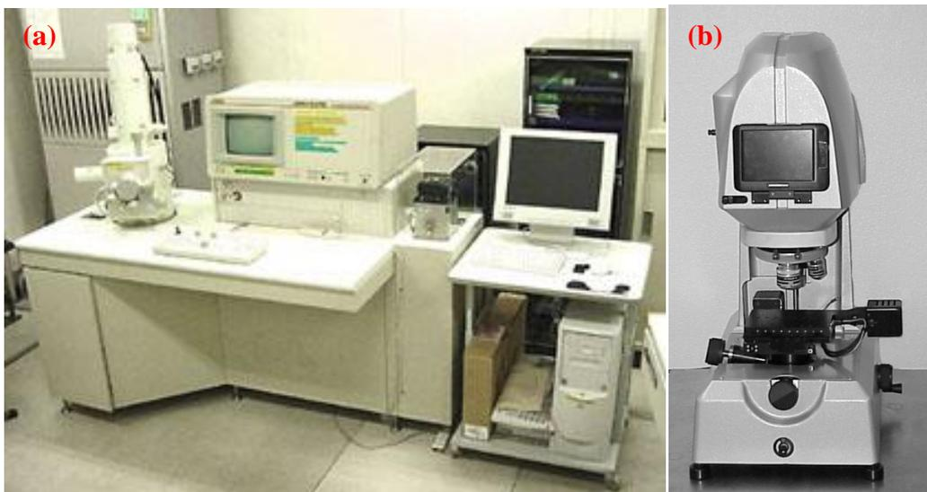
**Figura 4.5:** Imagens dos equipamentos utilizados na caracterização das amostras corroídas (a) MEV e (b) perfilmetro óptico.
