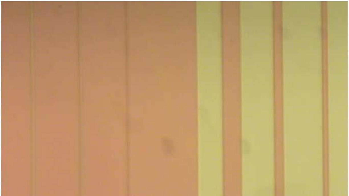
**Figura 4.4.** Micrografia da máscara de alumínio sobre o substrato de Si.
