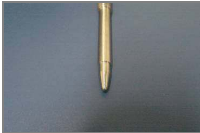
Figura 9 - Ponta da haste da Máquina EMIC, para ensaio de resistência à compressão.
