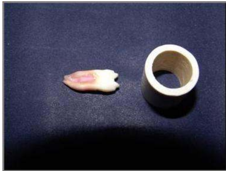
Figura 2 - Espécime já com Rubber-Sep aplicado na raiz e anel de embutimento.
