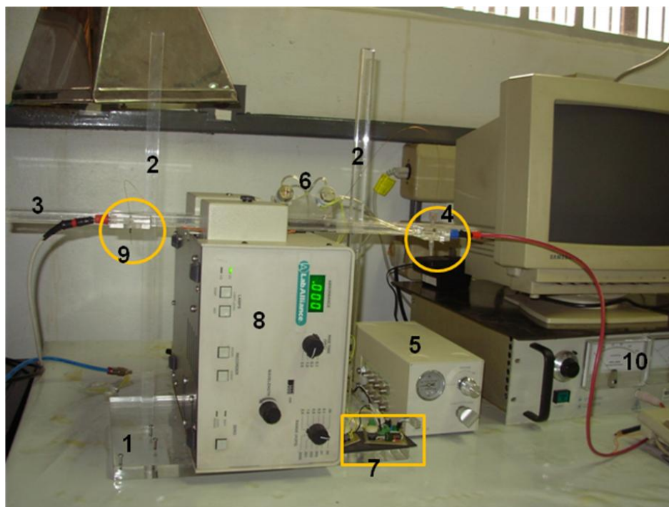
Figura 3.1 – Sistema de eletroforese capilar. Foto do sistema de eletroforese capilar projetado no Laboratório de Química Analítica do CENA. 1. Base, 2. Hastes, 3. Vareta, 4. Injetor, 5. Unidade controladora de gás, 6. Válvulas solenóide, 7. Circuito eletrônico, 8. Detector UV/Visível, 9. Recipiente coletor, 10. Fonte de alta voltagem.
