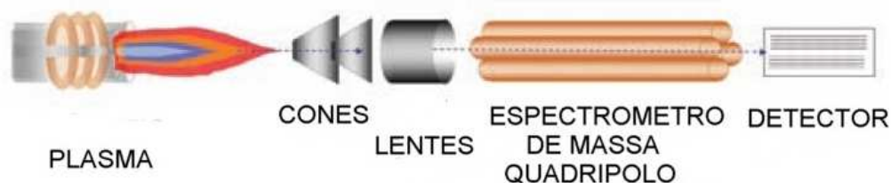
FIGURA 7- ESQUEMA DE UM ESPECTROMETRO DE MASSA COM PLASMA
