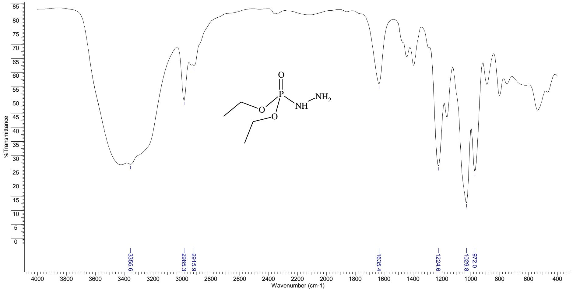
**Figura 48** - Infravermelho da dietilfosforilidrazina (5) em célula de NaCl.
