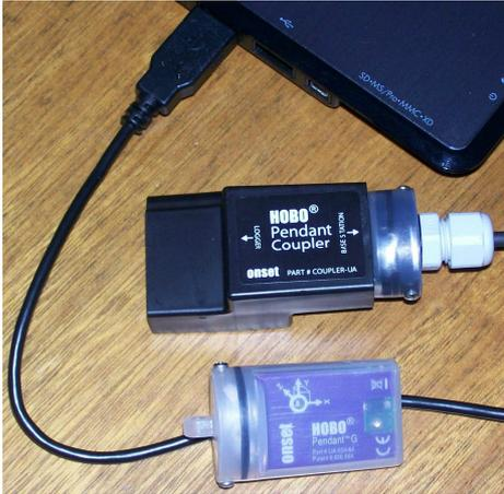
**Figura 8:** Data logger e cabo conector para o *download* das informações.
