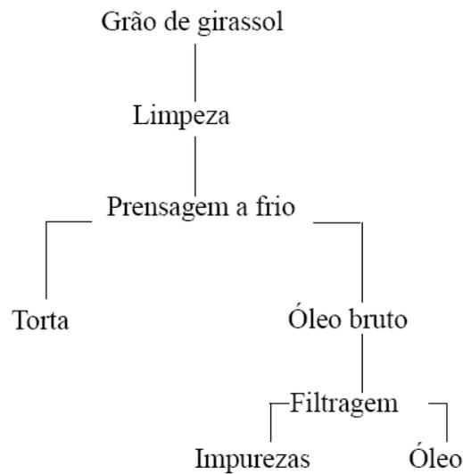
**Figura 1:** Fluxograma de extração da torta de girassol em pequena escala, em prensagem a frio utilizando miniprensa (OLIVEIRA et al., 2007).
