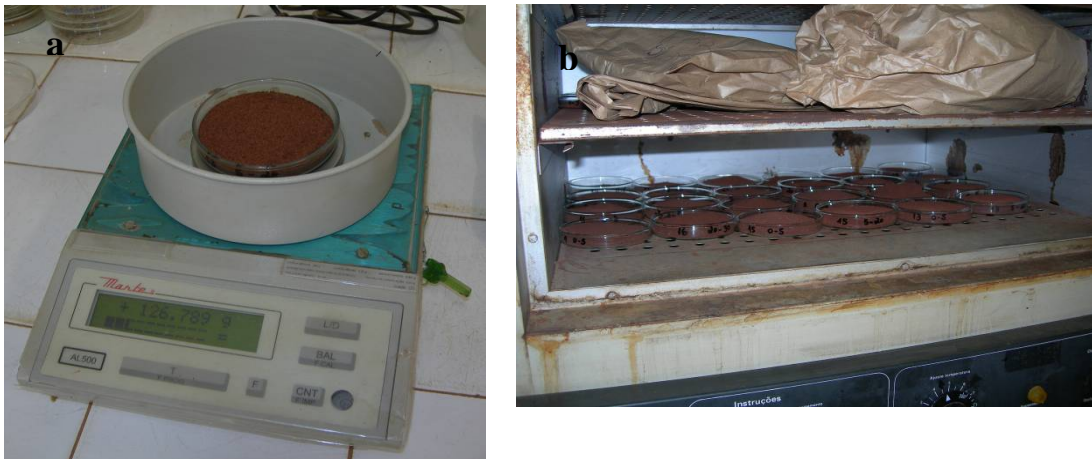
FIGURA 7– BALANÇA (a) E ESTUFA (b), UTILIZADAS PARA DETERMINAÇÃO DA UMIDADE DOS SOLOS DA USINA ALTO ALEGRE, MUNICÍPIO DE COLORADO – PARANÁ, DE NOVEMBRO 2007 A SETEMBRO 2008
