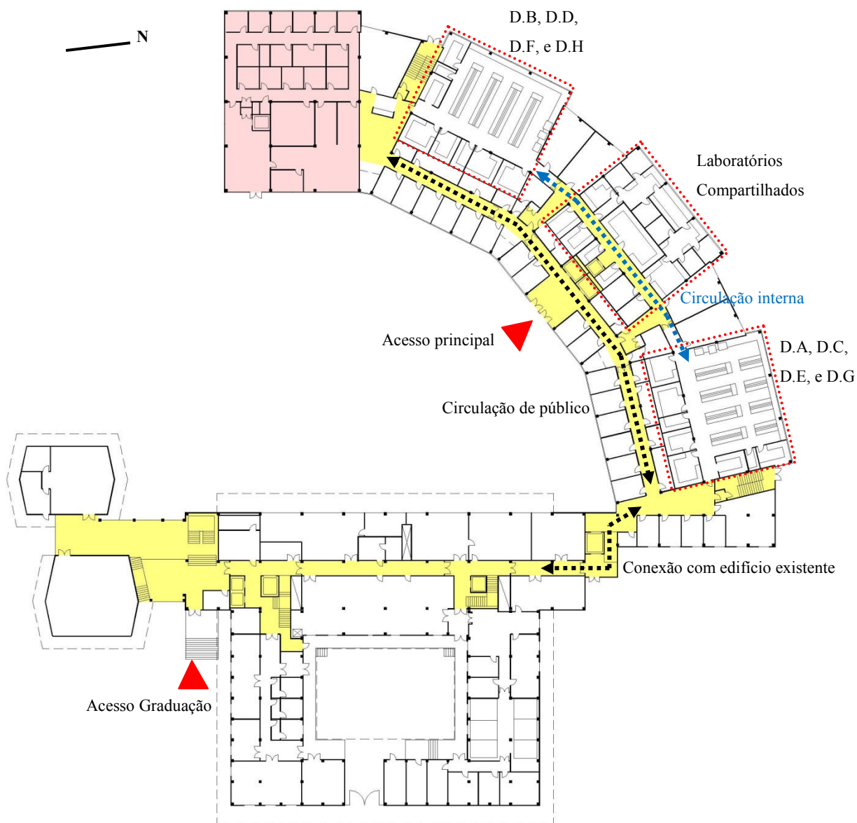
Figura 5.28. Planta do térreo ilustrando os conceitos estruturadores da arquitetura do Centro D: (1) circulações; (2) volumes dos departamentos D.A a D.H, e (3) acessos. Fonte: elaborado pelo autor com dados de BRAUN; GRÖMLING, 2005, p.88.
