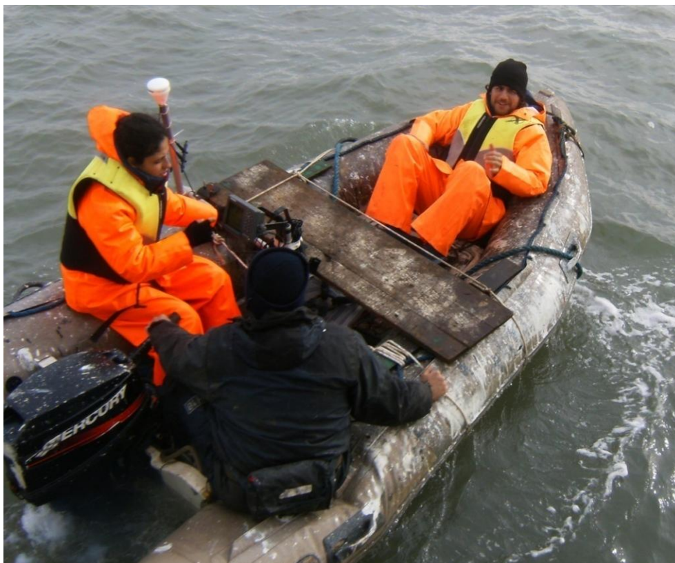
Figura 13- Bote no qual foram realizadas as sondagens na parte rasa. Nota-se a tela e a antena do GPS.
