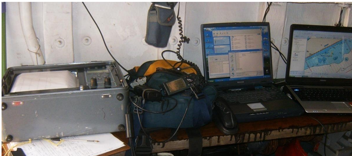
Figura 12 - Da esquerda para direita: Ecobatímetro, mochila do DGPS e computadores para acompanhamento da navegação.
