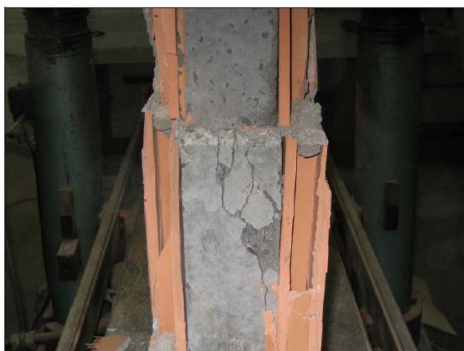
Figura 2.40 - Graute, interface bloco/argamassa. Grohmann (2006)
