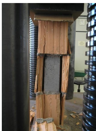
Figura 2.43 - Tipo de ruptura dos prismas grauteados. Leão (2008)
