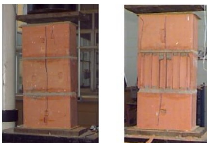
Figura 2.30 - Faces opostas de um prisma após a ruptura. Garcia (2000)
