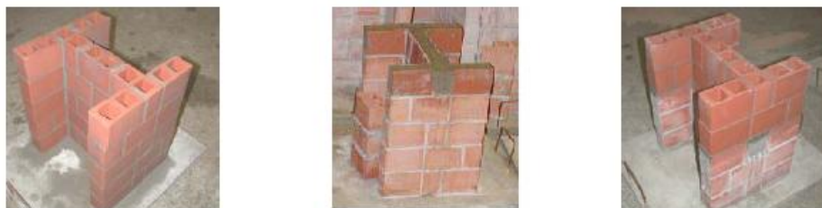
Figura 2.23 - Corpos de prova para ensaios de cisalhamento em escala reduzida (1:3). Capuzzo Neto (2005)
