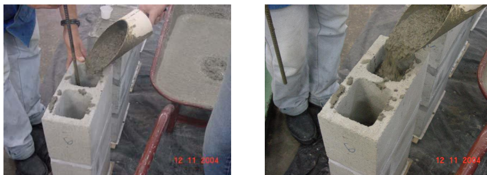
Figura 2.44 - Montagem dos prismas grauteados. Logullo (2006)
