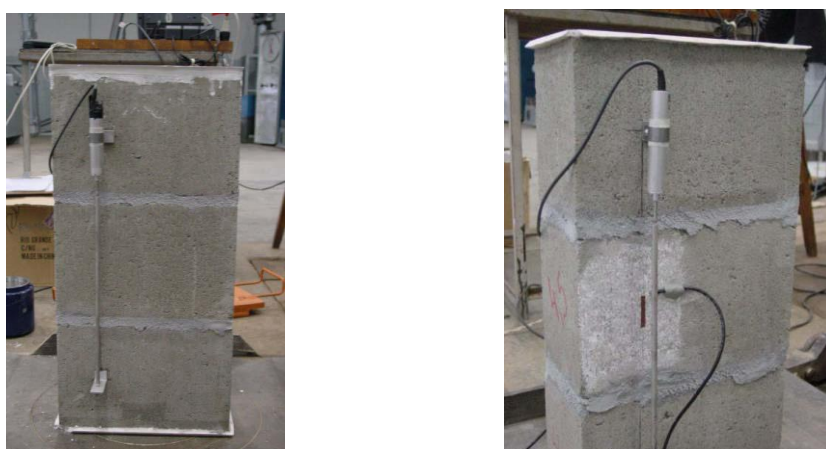
Figura 2.45 - Esquema da instrumentação dos prismas. Logullo (2006)
