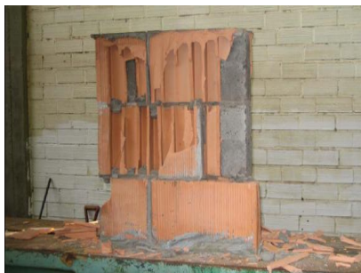
Figura 2.41 - Pilarete após a ruptura do prisma. Grohmann (2006)
