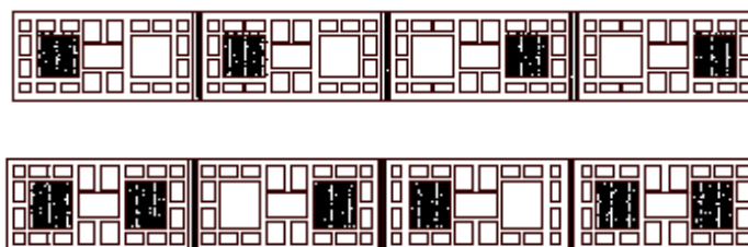
Figura 2.31 - Esquema de grauteamento das paredes. Garcia (2000)
