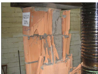
Figura 2.42 - Ruptura de prisma com graute de menor resistência. Grohmann (2006)
